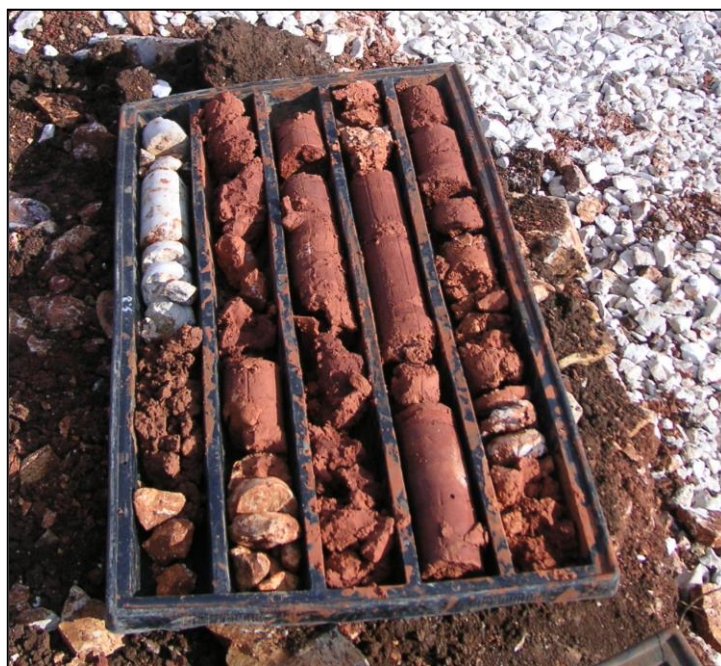
Foto 6 – Carotaggio in un potente deposito di terra rossa
