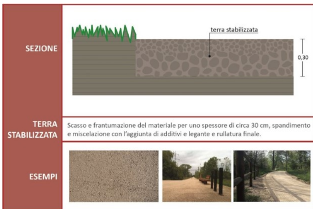
Figura 82 - Terra stabilizzata (fonte: linee guida, indirizzi tecnici e buone pratiche per la pianificazione, progettazione e realizzazione del sistema di mobilità ciclistica diffusa della Regione Sardegna)
