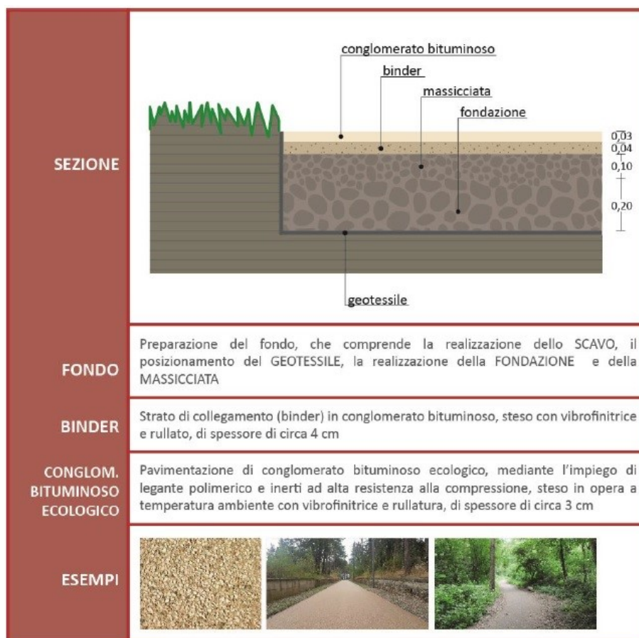
Figura 80 – Conglomerato bituminoso ecologico (fonte: linee guida, indirizzi tecnici e buone pratiche per la pianificazione, progettazione e realizzazione del sistema di mobilità ciclistica diffusa della Regione Sardegna)
